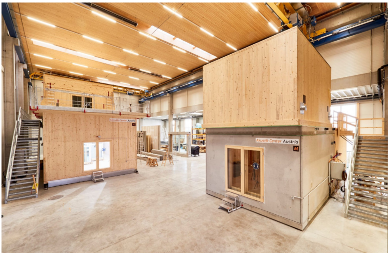
Abbildung 11: Innenansicht des Akustik Center Austria in welchem die Fassadensysteme auf ihr bauakustisches Verhalten hin untersucht wurden (© ACR/schewig-fotodesign).
