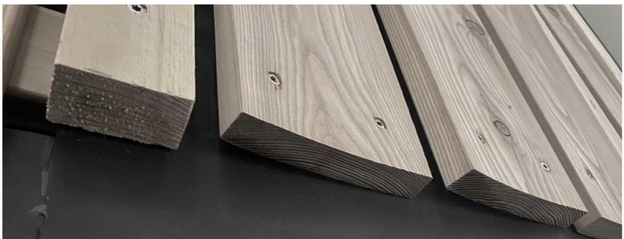
Abbildung 4: Durch die Bewitterung verformte (geschüsselte) Bretter beim Versuchsaufbau mit direkt an der Brettrückseite anliegender Fassadenbahn.
